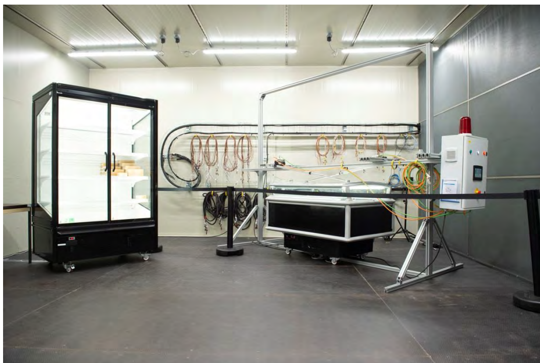
Cellule climatique Meubles Frigorifiques de Vente (MFV) du Cemafrroid de Fresnes
